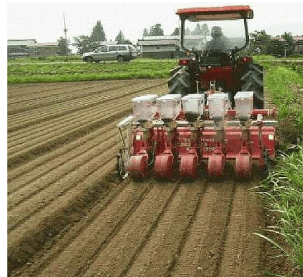
図 1 耕うん同時畝立て播種 (左：作業幅 170 cm の畝の形状、右：播種作業)
